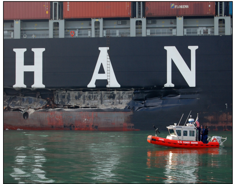
Một lỗ thủng trên con tàu chở hàng Cosco Busan đã làm tràn 53,000 ga-lông dầu tại Vịnh San Francisco vào năm 2007.
